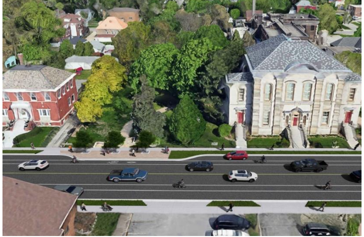
Cette image conceptuelle montre un espace de rassemblement, des pavés préfabriqués dans une palette de couleurs historiques, des grilles d'arbres patrimoniales, des arbres plantés dans des cellules de sol pour permettre une plus grande croissance du couvert végétal et des boulevards de gazon.
