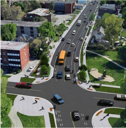
Cette image conceptuelle montre les dalles de trottoir tactiles au fini patrimonial, les espaces de rassemblement, les arbres plantés dans des cellules de sol pour permettre une plus grande croissance du couvert végétal et les boulevards de gazon.
